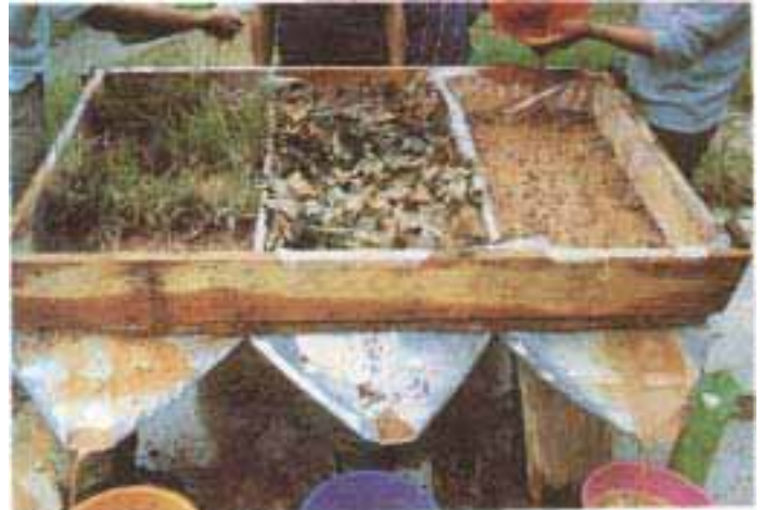
Caja de erosión con diferentes grados de cobertura del suelo, al centro: La capa de humus y hojarasca protegen el suelo y absorben una gran cantidad de agua.
