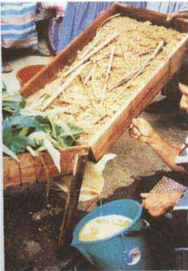
Caja de erosión, lado izquierdo con materia orgánica y vegetación, lado derecho sin vegetación. El agua está escurriendo del lado "chaqueado"
